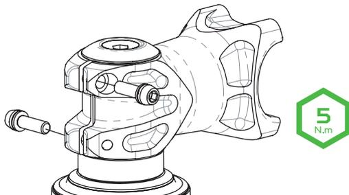
**004\_**Positionnez le cintre et sa bride de serrage, insérez d'abord les 2 vis de serrage supérieures (préalablement graissées) et serrez-les légèrement. Lorsque vous êtes satisfait de l'inclinaison de votre guidon, serrez les 2 vis au couple de serrage recommandé de **5 N.m.** Serrez les vis alternativement jusqu'à obtention du couple désiré. Vérifiez qu'il existe bien un espace entre la partie inférieure de la bride du cintre et la potence. **Voir Figure D.**
