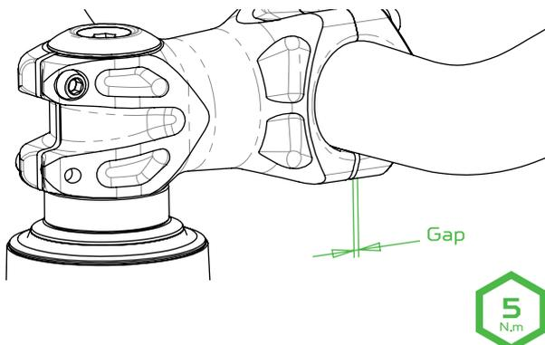
**005\_**Installez les 2 vis de serrage inférieures et serrez les alternativement au couple de serrage de **5 N.m.** **Voir Figure E.**
