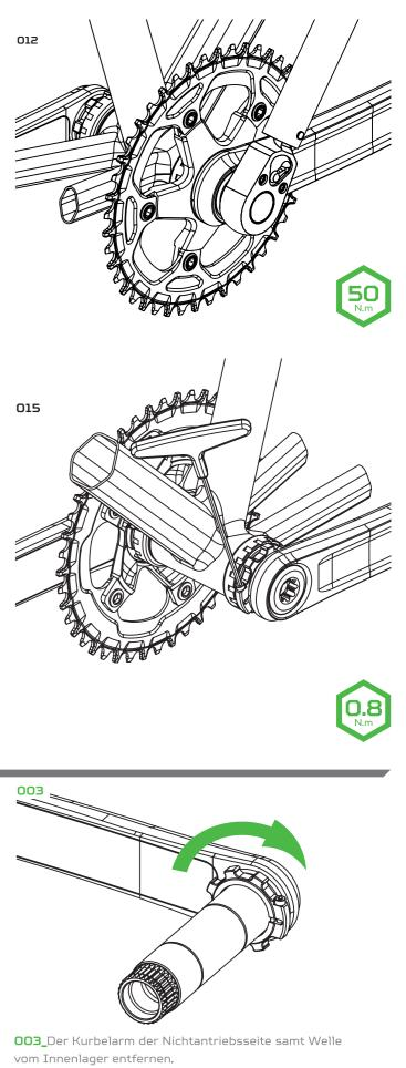
**004\_**Die Klemmschraube an der Vorspannungsmutter mit einem 2.5mm Allenschlüssel lösen. Die Vorspannungsmutter wie in der Abbildung 003 drehen, damit es keinen Abstand zum Kurbelarm der Nichtantriebsseite gibt.
