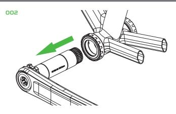
**002\_**Continuez à tourner le boulon dans le sens inverse des aiguilles d'une montre, il se desserrera et vous sentirez de la résistance lorsque la manivelle commencera à s'extraire de l'axe, continuez à tourner jusqu'à ce que la manivelle côté transmission se détache complètement de l'axe.
