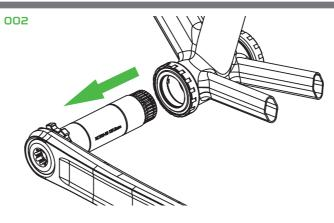
**002\_**Die Schraube immer noch im Gegenuhrzeigersin drehen. Sie wird zuerst locker und gleich danach gibt es Widerstand, als der Kurbelarm langsam von der Welle abgezogen wird. Weitermachen bis der Kurbelarm von der Welle komplett entfernt wird.
