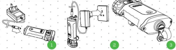
**DANGER:** Utilisez uniquement la batterie Li-Ion 7.4V fournie avec le système d'éclairage. Toute tentative d'utiliser ou de charger un autre bloc de piles peut entraîner une explosion et des blessures graves. Le chargeur de piles est conçu pour une utilisation à l'intérieur uniquement et ne doit pas entrer en contact avec l'eau. La prise de courant doit être facilement accessible.
